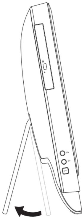
**⚠ WARNUNG:** Tragen Sie den Computer nicht am Standrahmen und drehen Sie den Computer nicht mit der Unterseite nach oben.
